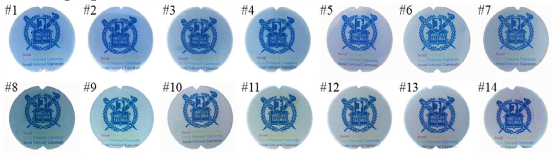
[그림 2] 나노 폰(pawn) 구조체를 이용한 다중-채널 컬러필터 효과
